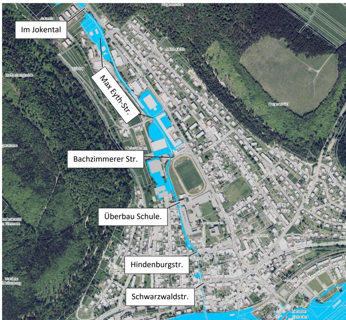
Bild 2: Ortslage mit Weisenbach, Querungsbauwerken und Überflutungsflächen nach HWGK bei einem HQ<sub>100</sub> (hellblau)
